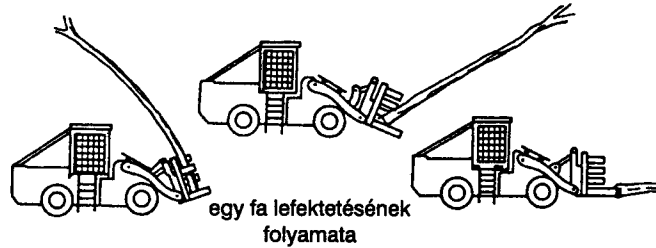
412. ábra. Döntő-rakásoló gép munka közben
